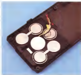
Sezione con l'alimentazione temporanea assicurata da cinque batterie a bottone ricaricabili di cui una è non la capsula del modem.
